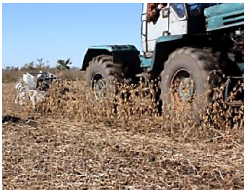
Рисунок 2. Работа Т-150К с экспериментальной очесывающей жаткой на опытном поле.
